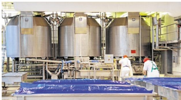
Drei Käsefertiger stehen im Holtseer Betrieb. Sie alle werden von einem Mitarbeiter gleichzeitig gesteuert.
